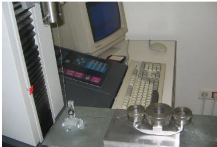
图 11：滑动距离力的测定 (注意添加到测试脚上的附加质量)
