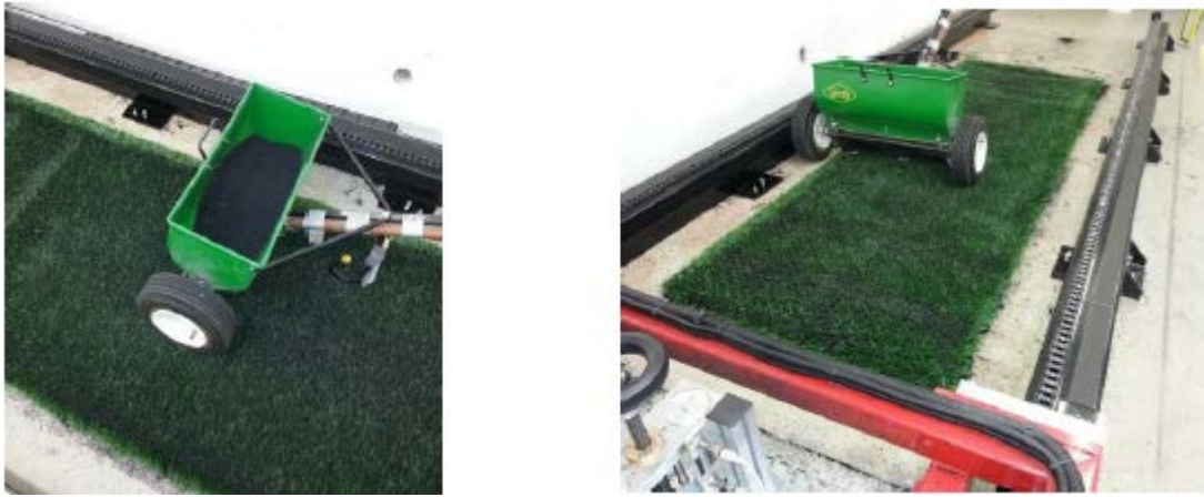
图 18——分散的填料重新分配
